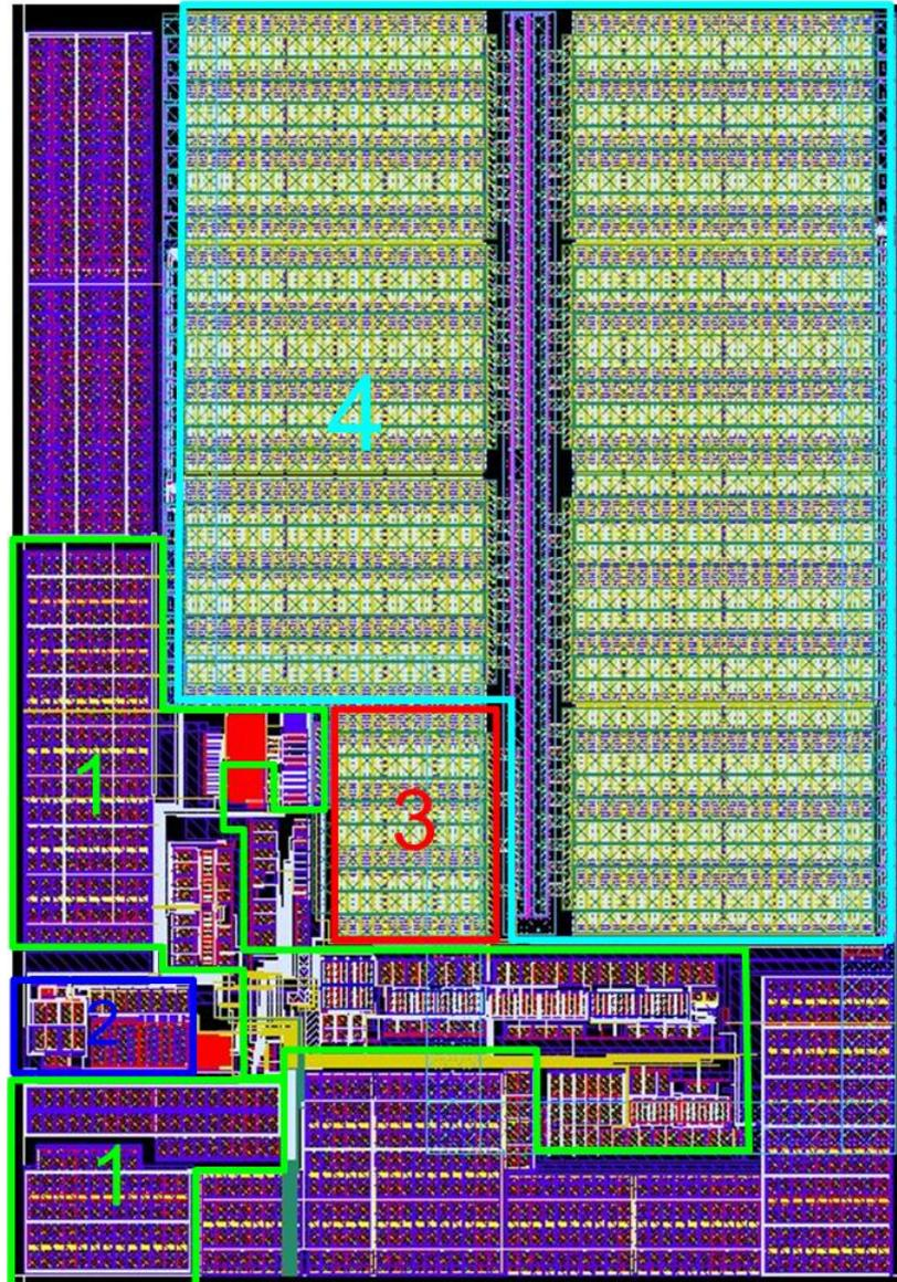
Рисунок 2: Общий вид топологии блока регулятора напряжения
